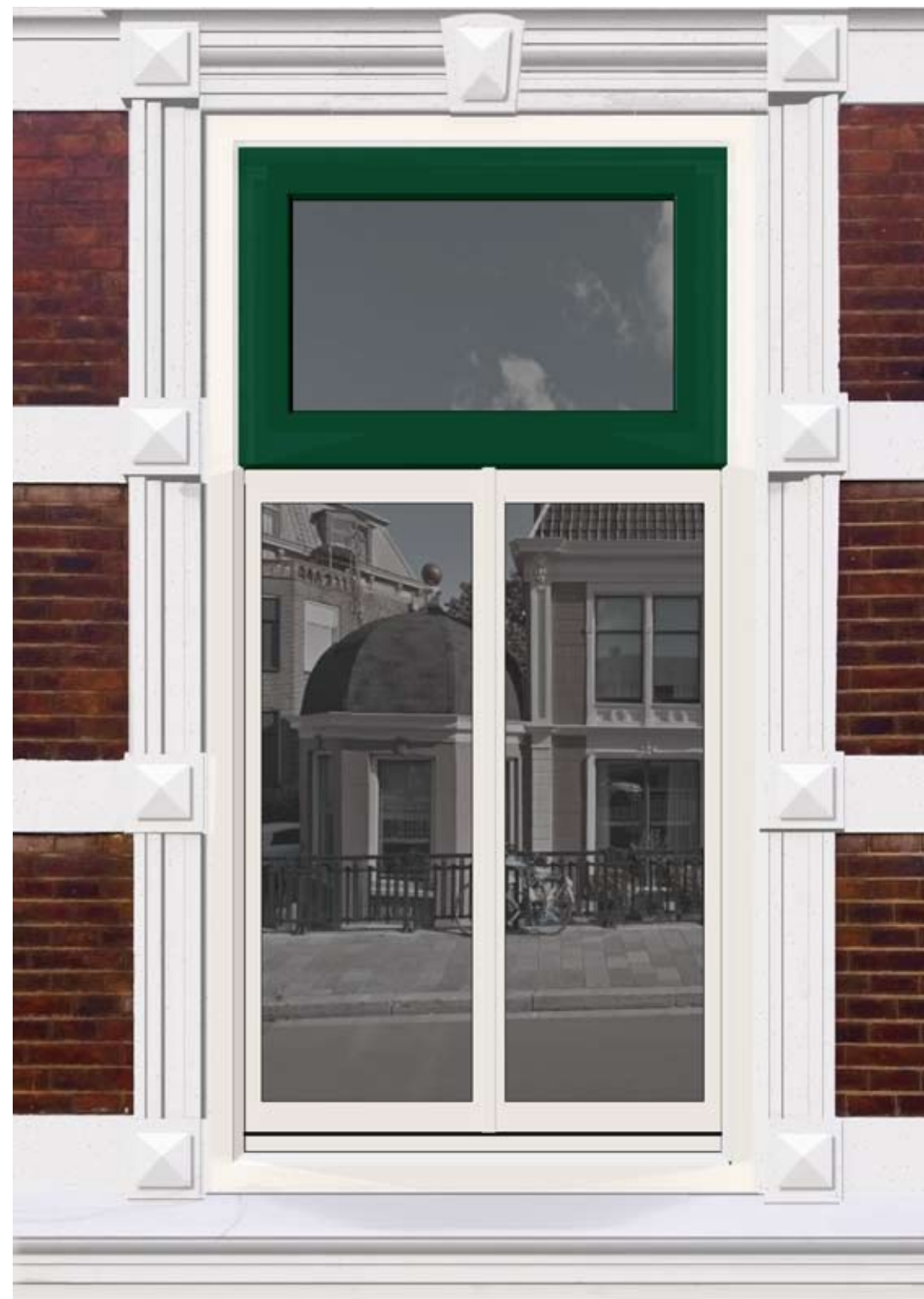
Onstoring door reparatie natuursteen en metselwerk en nieuwe houten kozijn
